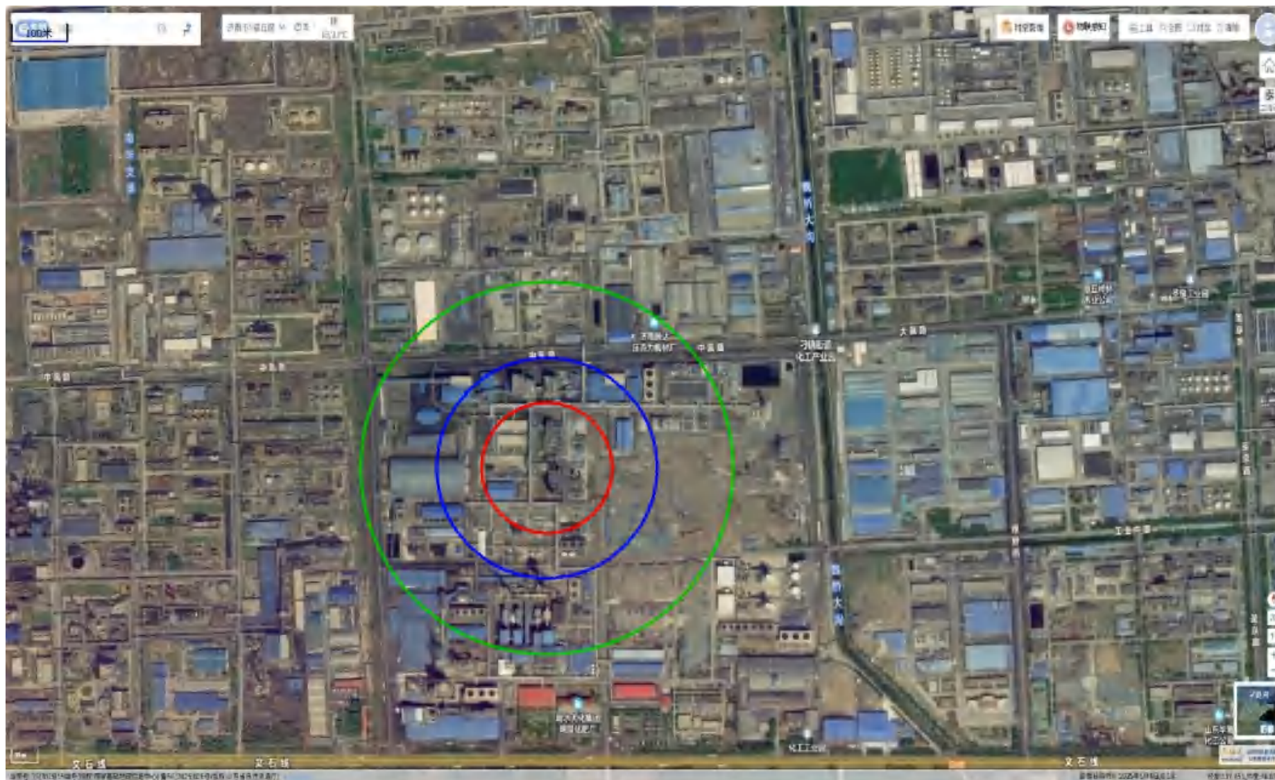
图 C-3-4 低甲：变换气洗涤塔塔器完全破裂云爆事故后果图
