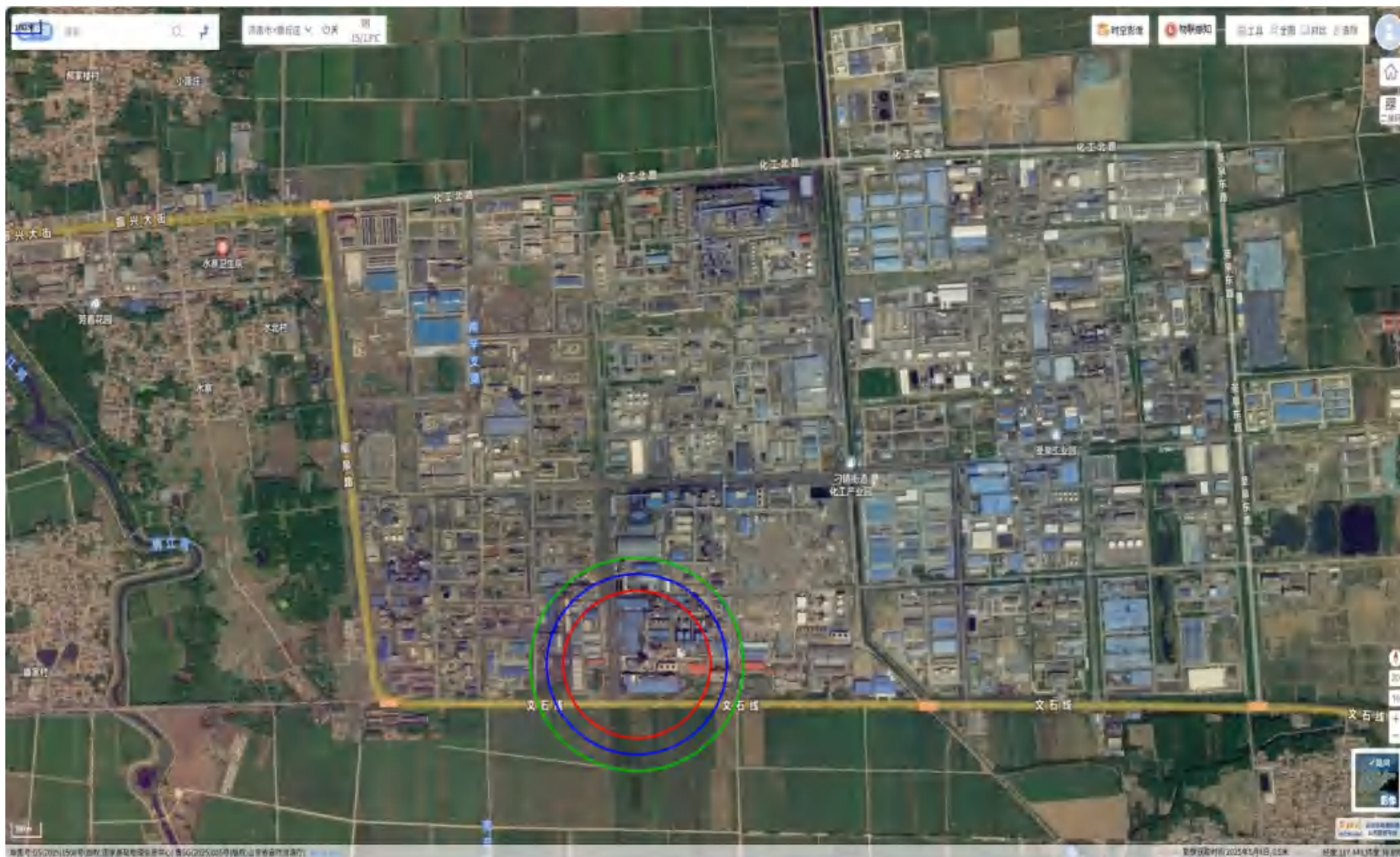
图 C-3-16 2#尿素：液氨缓冲罐容器整体破裂（中毒扩散：2.7m/s, D 类）事故后果图
