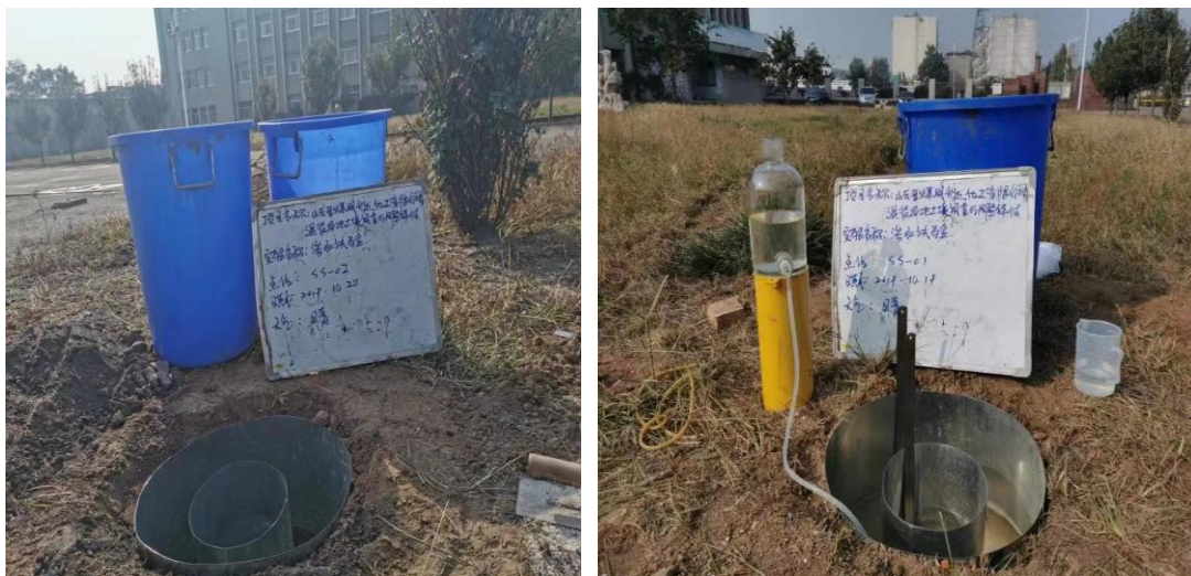
图 4.1-5 现场渗水试验
